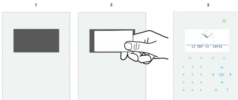
Se la tastiera è dotata di un ricevitore di prossimità, gli utenti devono posizionare il fob a 1 cm dall'area di ricezione del lettore tessere.
